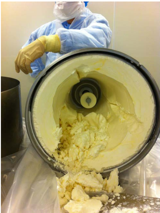
Het oogsten van het tussenproduct Baxter Precipitate G uit de centrifuge
